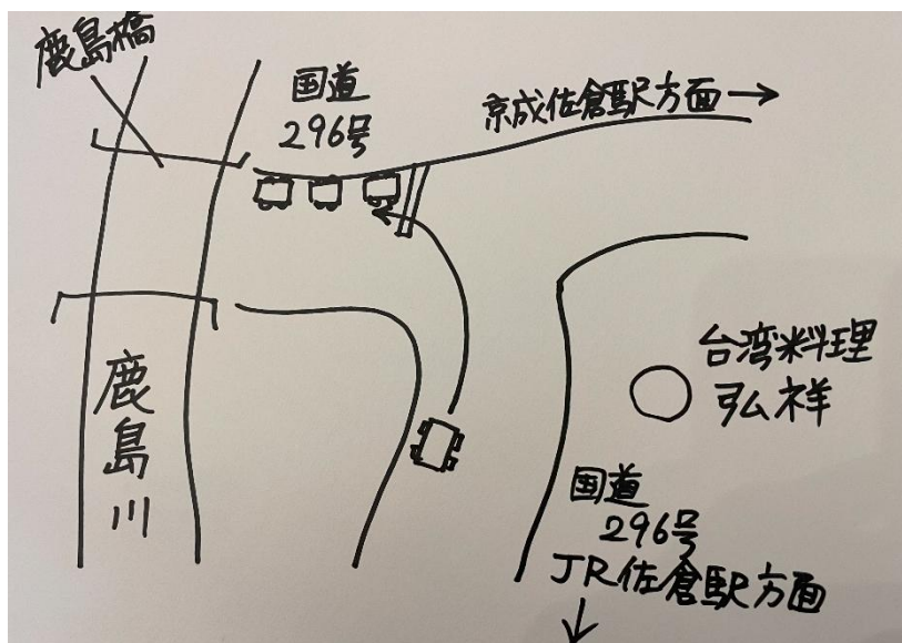
【図2】左図のように、左折車両が誤って右折車線に進入するケースが多く発生している。左折車両からは、当該箇所は軽い上り坂になっているため、車線そのものが見づらいこととあわせ、そもそも当該箇所の路面標示が消えかかっているため、このような問題が発生するものと考えられる。
